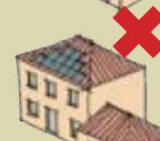
Les toitures 4 pentes sont particulièrement inadaptées à l'installation de panneaux.
